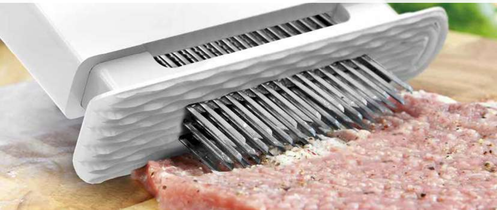
Nože manuálního tenderizéru.
